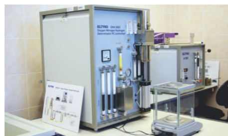
↑ Анализатор Eltra ONH 2000 с модулем Eltra H500 для определения содержания диффузионно-подвижного водорода в наплавленном металле. Анализатор для определения содержания углерода и серы ELTRA CS 2000
