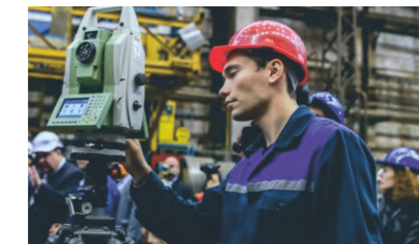
↑ Тахеометр Leica TDRA 6000. Высокоточный инструмент, осуществляющий геометрические измерения в пространстве и математическую обработку данных
