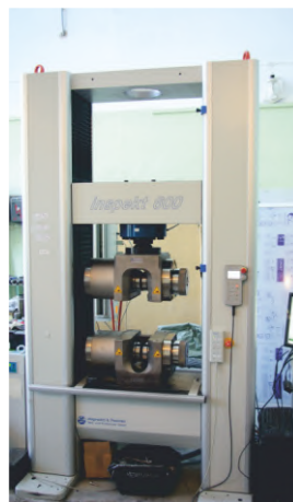
↑ Универсальные испытательные машины INSPECT 600 и INSPECT 100 с высокотемпературной печью до 1200°C для определения механических характеристик
