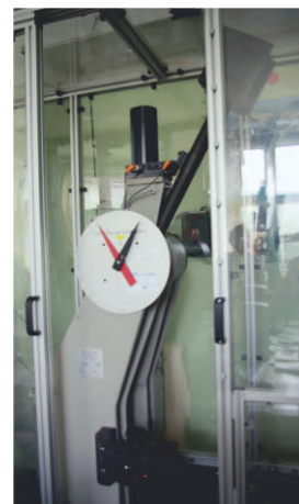
↑ Маятниковый копер PH-300 для определения работы удара по ГОСТ и ASME
