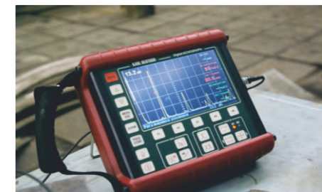
↑ Isonic 2010. Дефектоскоп с использованием ультразвуковых фазированных решеток (УЗФР). Сканирование методом «тандем». Сканирование методом TOFD
